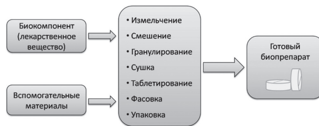
Технологическая схема получения таблетированной формы биопрепарата
