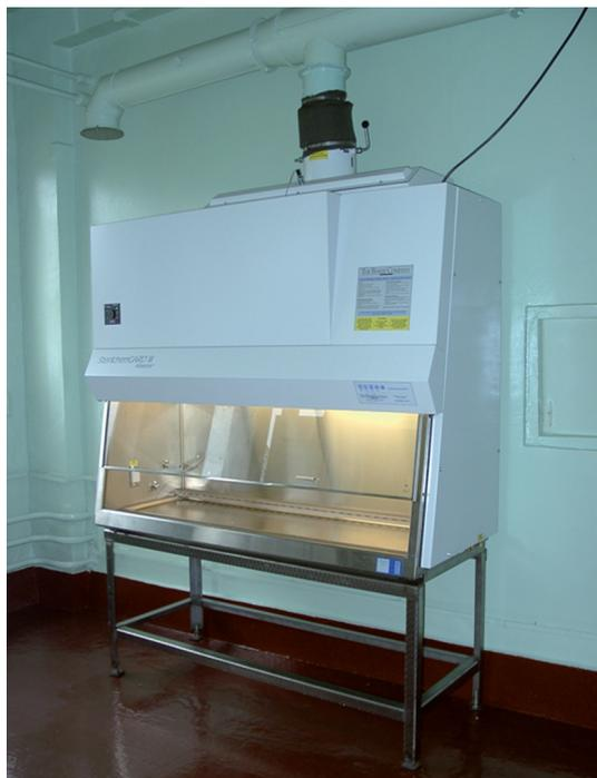
Рис. 3. Бокс биологической безопасности II класса, тип В
