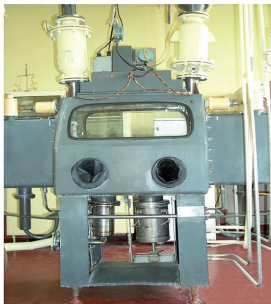
Рис. 2. Бокс биологической безопасности III класса 4-БП-2-М
